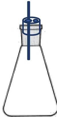
Figura 1. Matraz Erlenmeyer con tapón perforado y tubo y termómetro
