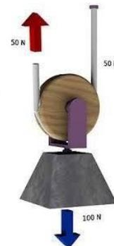
Figura 3. Polea móvil con una sola polea.
