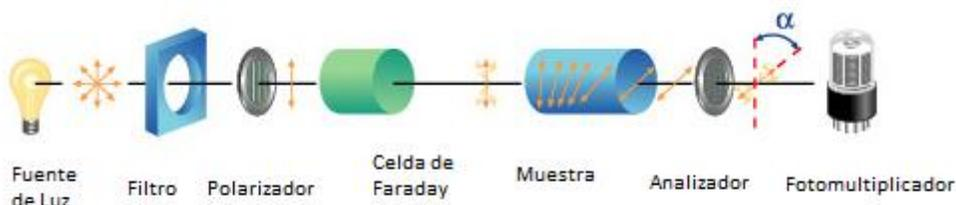
**POLARIMETRÍA.-** La actividad óptica es una medida de la capacidad de ciertas sustancias para hacer girar la luz polarizada en un plano, puede definirse como el estudio de la rotación de la luz polarizada por sustancias transparentes. La dirección y la rotación ( potencia rotatoria óptica ) es útil para el análisis cualitativo y cuantitativo y para la elucidación de estructuras químicas.
