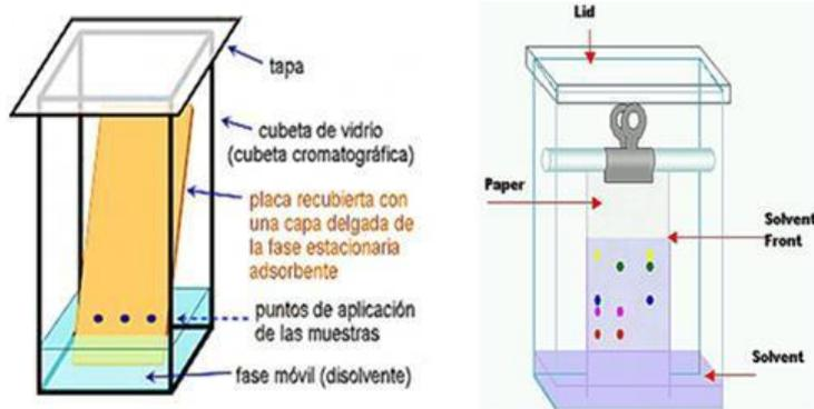
Fig. 31 Realización de cromatografía en capa fina
